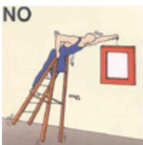
Onde evitare il ribaltamento della scala pieghevole, è necessario mantenere il proprio baricentro più all'interno possibile, senza sbilanciarsi verso l'esterno.
