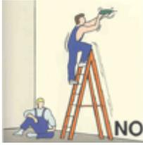
Particolare attenzione deve essere prestata quando si impiegano attrezzature o si effettuano lavori ingeneranti spinte orizzontali, che potrebbero far scorrere la scala sul pavimento, specialmente se sdruciolevole.
